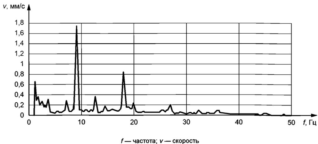
Рисунок С.2 — Спектр Фурье для постоянной угловой скорости  $n = 108 \text{ мин}^{-1}$
