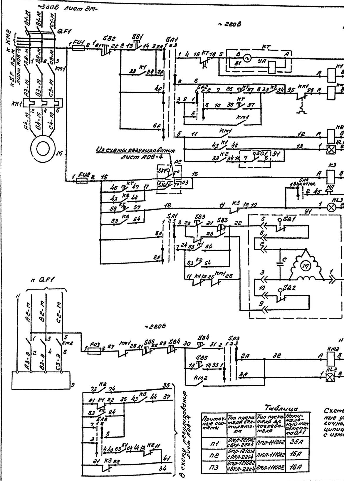
Управление электродвигателем приточного вентилятора (п2, п3)
