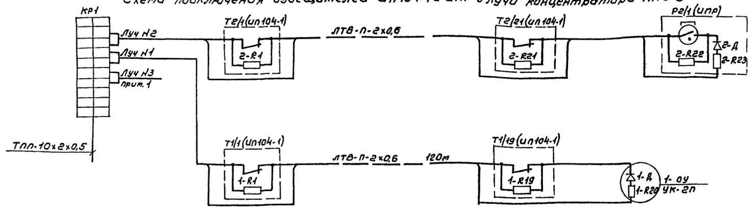
Схема подключения реле отключения вентиляции (РОВ) к концентратору ППС-3
