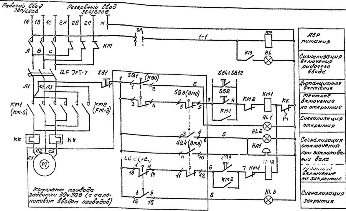
Комплект привода задвижки 304906 (с самоником вводом приводов)
