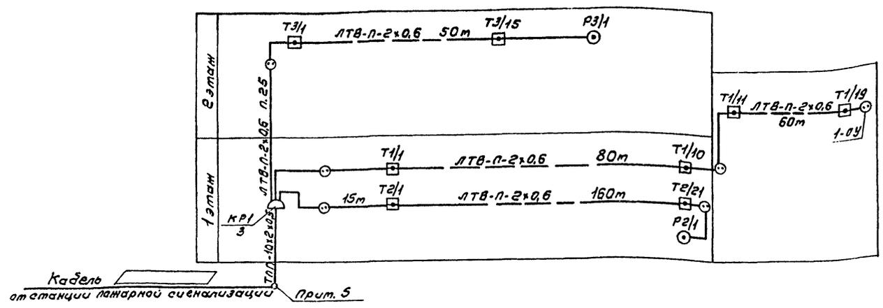
Схема подключения извещателей УП104-1 и УПР в лучи концентратора ППС-3
