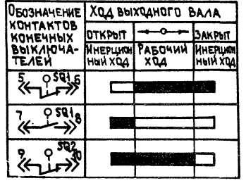
КОНЕЧНЫХ ВЫКЛЮЧАТЕЛЕЙ ИСПОЛНИТЕЛЬНОГО МЕХАНИЗМА МВ1
