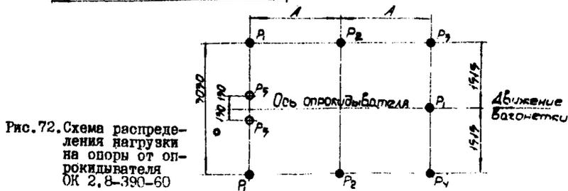
Рис. 72. Схема распределения нагрузки на опоры от опрокидывателя ОК 2,8-390-60
