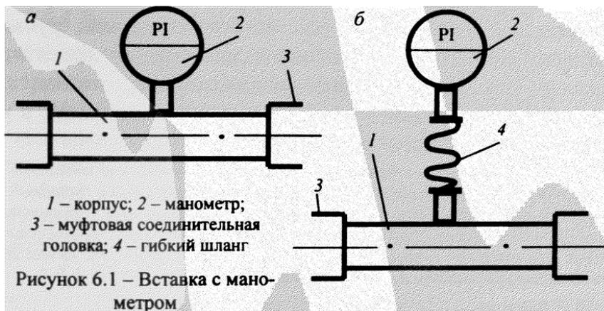
6.3.1.4 Выбор места размещения измерительной вставки и необходимость использования гибкого шланга определяет испытатель в зависимости от удобства проведения испытаний.
