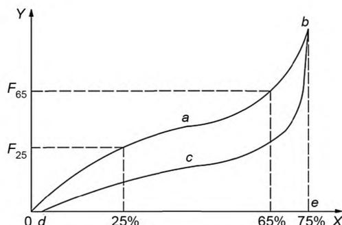
X — вдавливание, %; Y — нагрузка F; a — типичная кривая цикла нагружения; b — верхняя точка; c — типичная кривая цикла разгрузки; d — конечная точка; e — точка, соответствующая 75 % вдавливания образца для испытания
