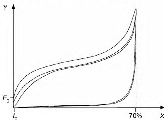
X — вдавливание, %; Y — нагрузка, F;  $F_0$  —  $5^0_2$ , Н, предварительная нагрузка, при которой измеряется исходная толщина;
