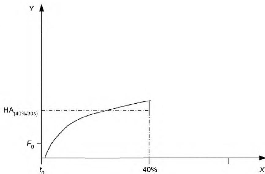
X — вдавливание, %; Y — сила,  $F; F_0 — 5^0_2$  Н, нагрузка при предварительном нагружении, при которой измеряется начальная толщина образца для испытания;  $t_0$  — начальная толщина образца для испытания; HA — твердость, измеренная при применении режима А
