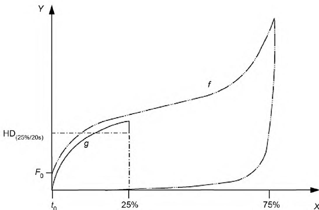
$X$  — вдавливание, %;  $Y$  — сила,  $F$ ;  $F_0$  —  $5^0_2$  Н, нагрузка при предварительном нагружении, при которой измеряется начальная толщина образца для испытания;  $f$  — кривая предварительного вдавливания;  $g$  — кривая вдавливания при испытании;  $t_0$  — начальная толщина образца для испытания;  $HD$  — твердость, измеренная при применении режима D
