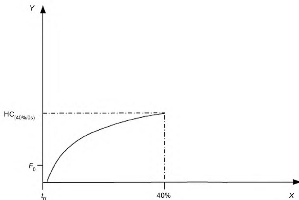
$X$  — вдавливание, %;  $Y$  — сила,  $F$ ;  $F_0$  —  $5^0_2$  Н, нагрузка при предварительном нагружении, при которой измеряется начальная толщина образца для испытания;  $t_0$  — начальная толщина образца для испытания;  $HC$  — твердость, измеренная при применении режима С
