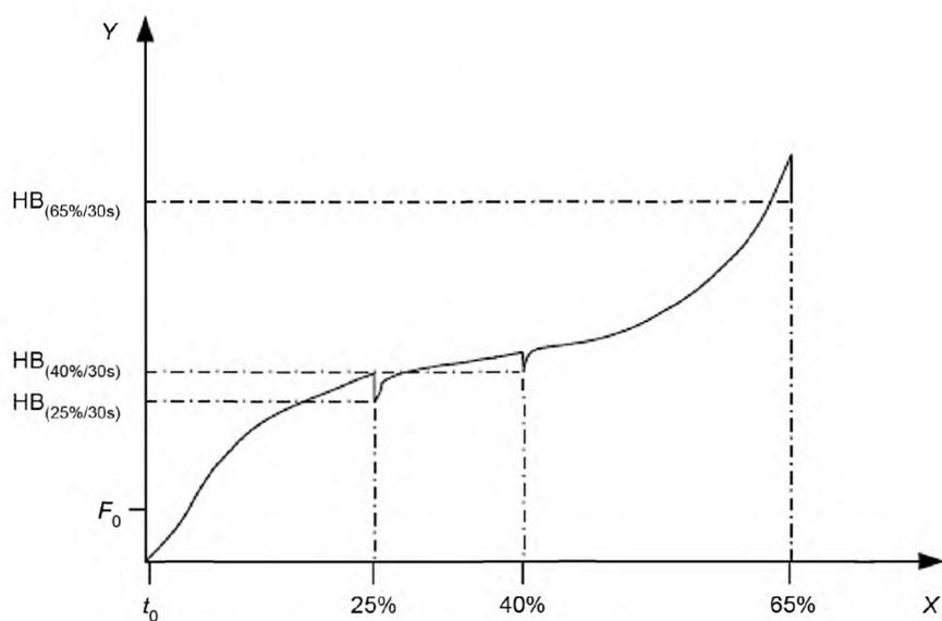
X — вдавливание, %; Y — сила,  $F; F_0 — 5^0_2$  Н, нагрузка при предварительном нагружении, при которой измеряется начальная толщина образца для испытания;  $t_0$  — начальная толщина образца для испытания; HB — твердость, измеренная при применении режима В
