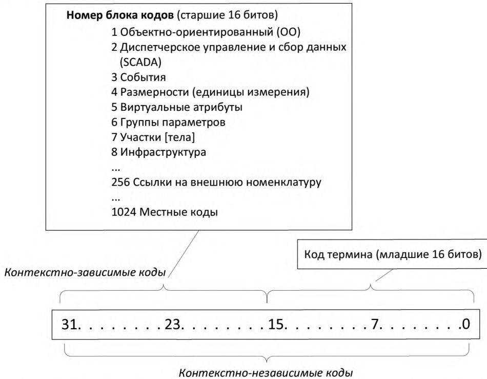
Рисунок 9 — ИСО/ИИЭР 11073-10101:2004(E) [B41]: сборка контекстно-независимых кодов из кода блока и конкретных терминов в блоке
