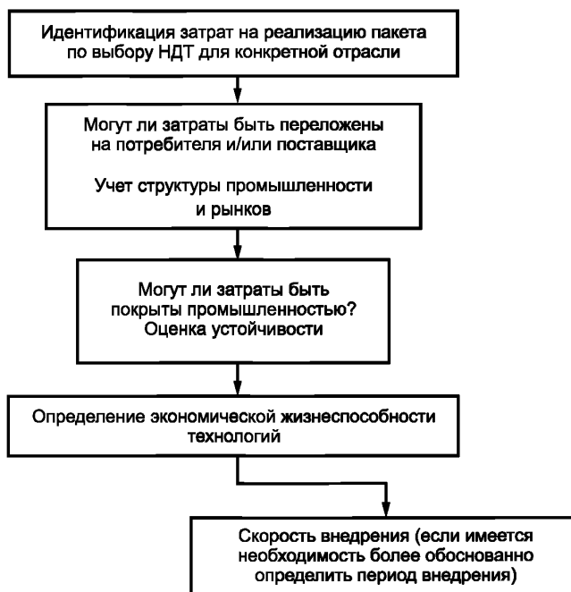
Рисунок 4 — Обобщенный алгоритм чередования аспектов оценки ожидаемой «экономической жизнеспособности» применения НДТ в отрасли промышленности
