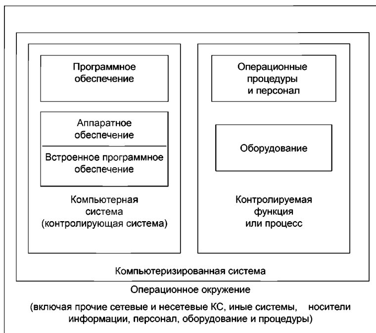
Рисунок 1 — Схема взаимодействия различных компонентов КС в ее операционном окружении
