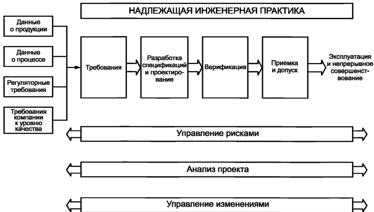
Рисунок 1 — Процесс разработки спецификаций, проектирования и верификации
