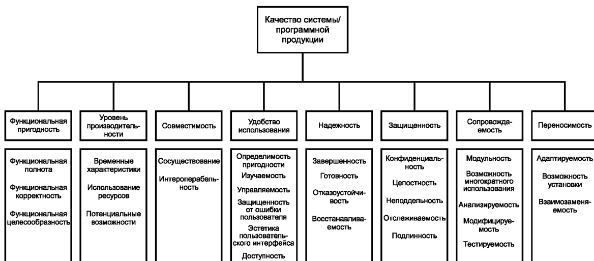
Рисунок 3 — Модель внешнего и внутреннего качества, показывающая характеристики и подхарактеристики
