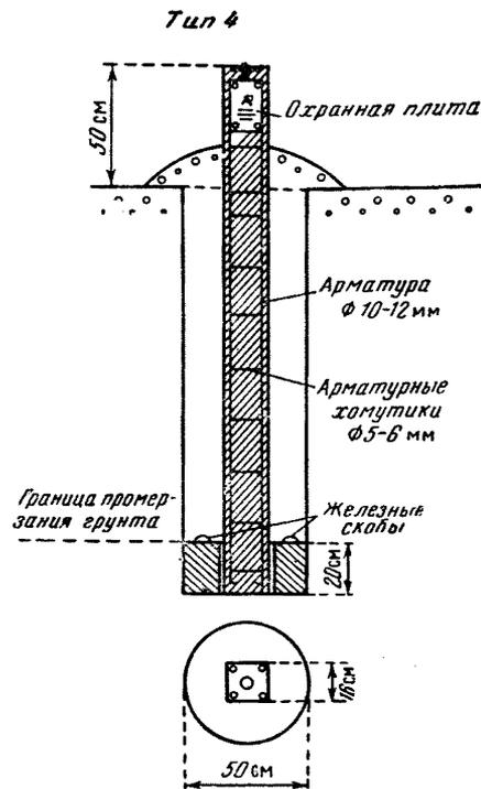
Рис. 1. Грунтовый репер нивелирования I, II, III, IV классов для северной зоны и грунтовый репер нивелирования I, II классов для южной зоны сезонного промерзания грунтов
