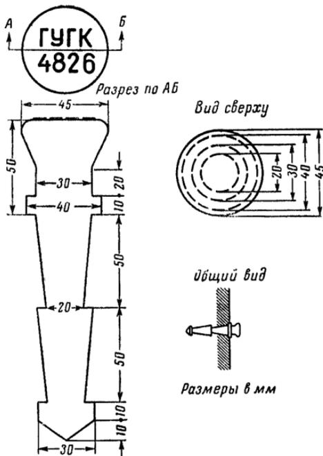
Рис. 9. Стенной репер
