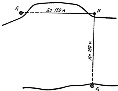
Рис. 15. Схема нивелирования через препятствие
