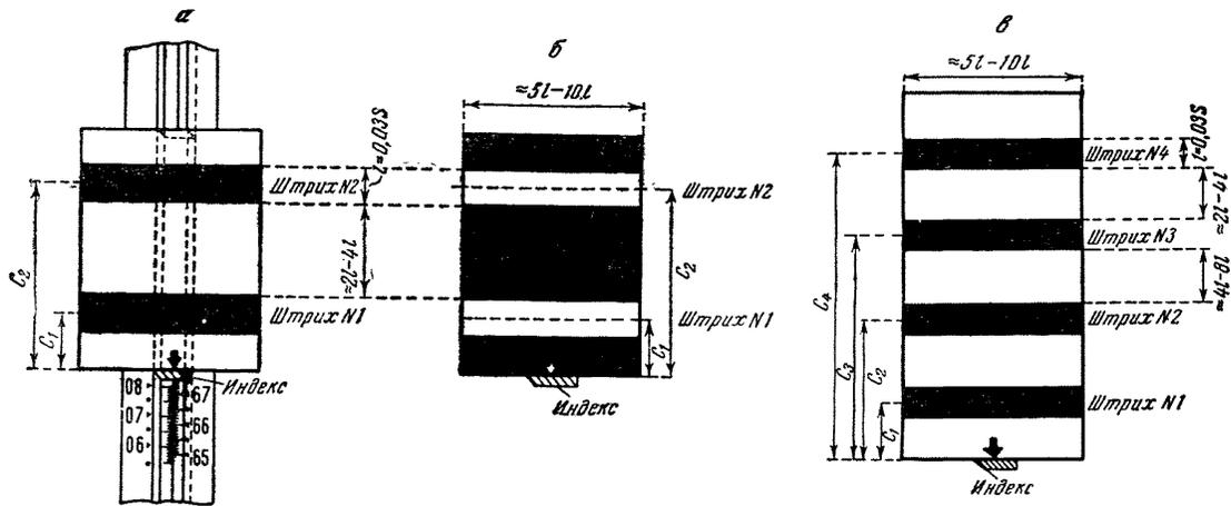
Рис. 24. Щитки для нивелирования через препятствие способом:
