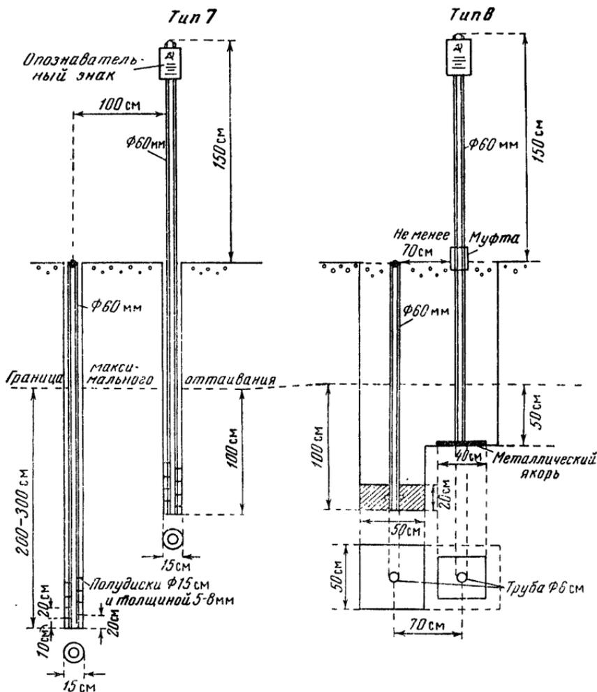
Рис. 7. Грунтовые реперы в зоне распространения многолетней мерзлоты
