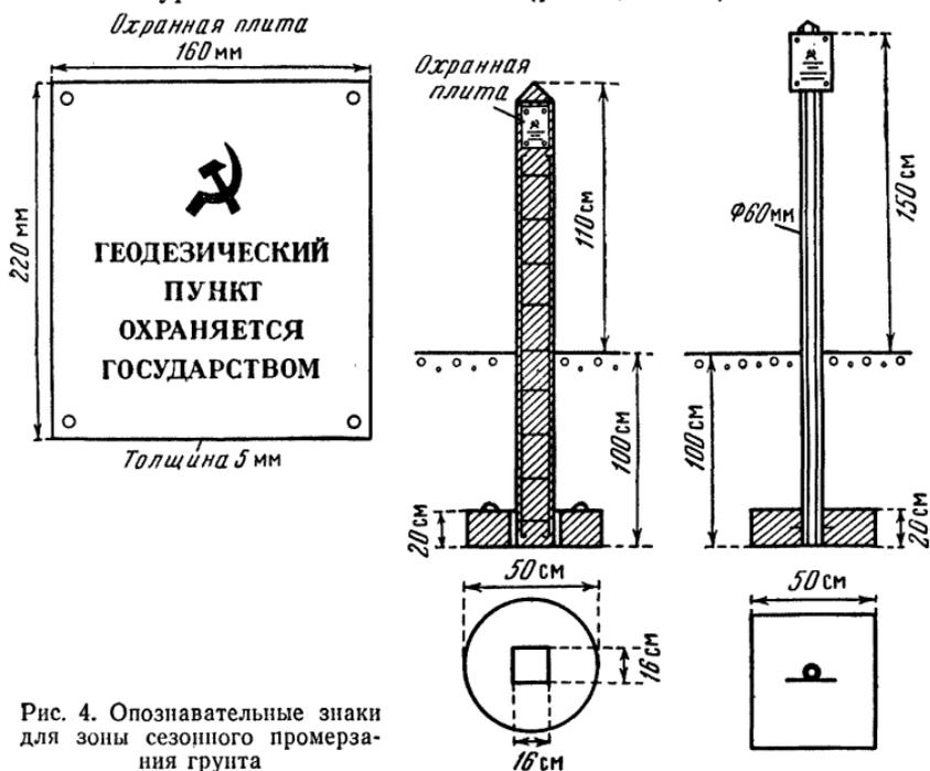
Рис. 4. Опознавательные знаки для зоны сезонного промерзания грунта
