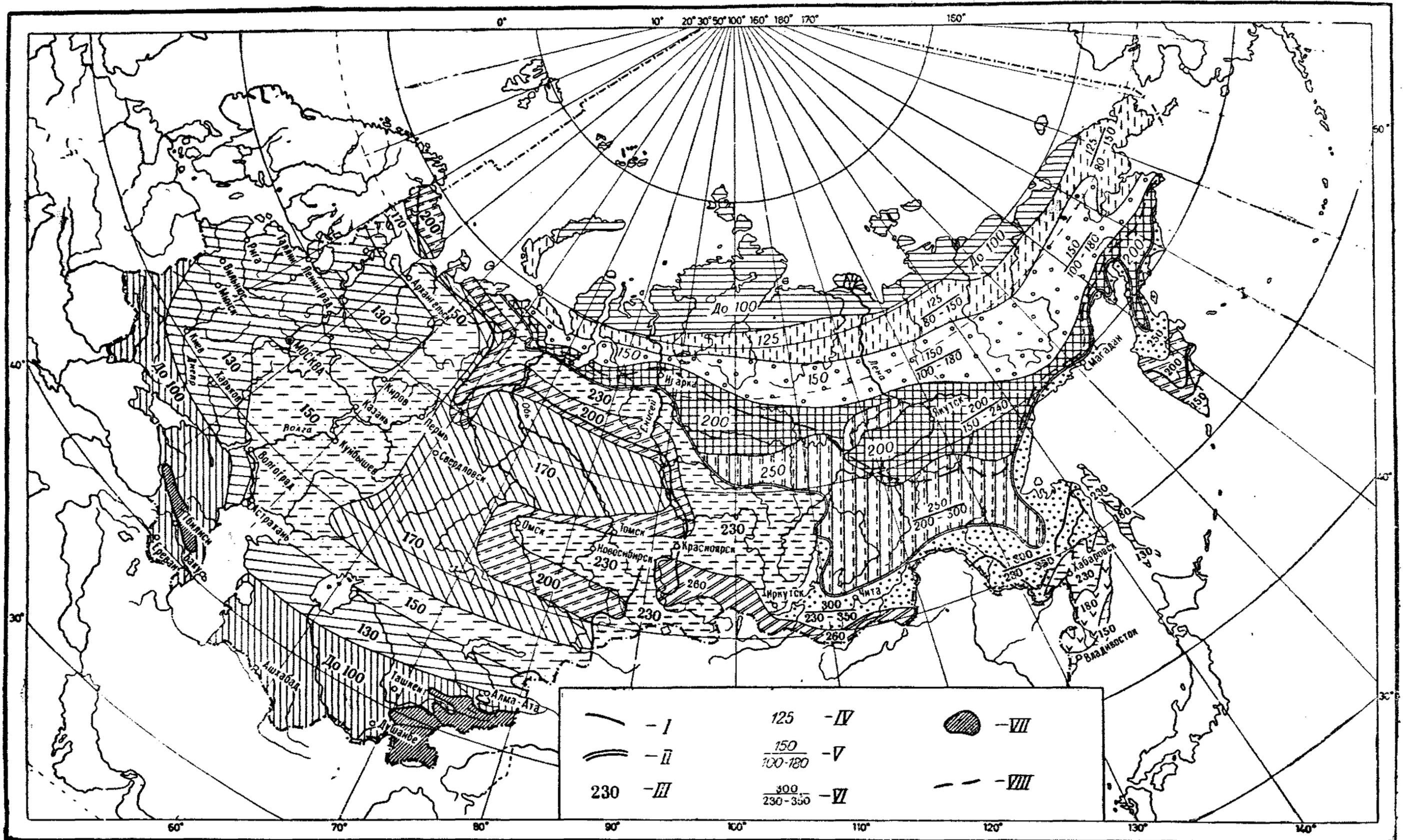
**Схематическая карта глубин промерзания и протаивания грунтов на территории СССР для установления глубины закладки центров и реперов**
