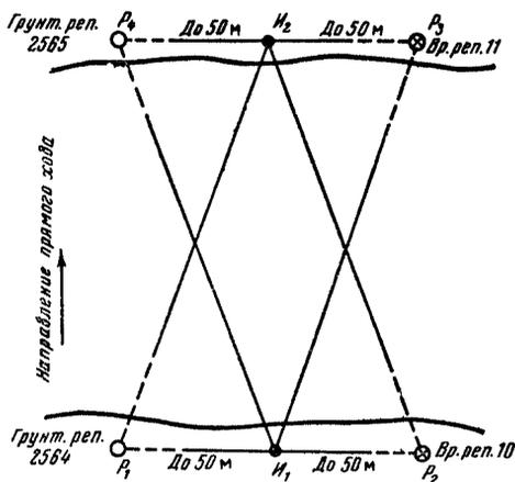
Рис. 18. Схема нивелирования через препятствие шириной более 150 м
