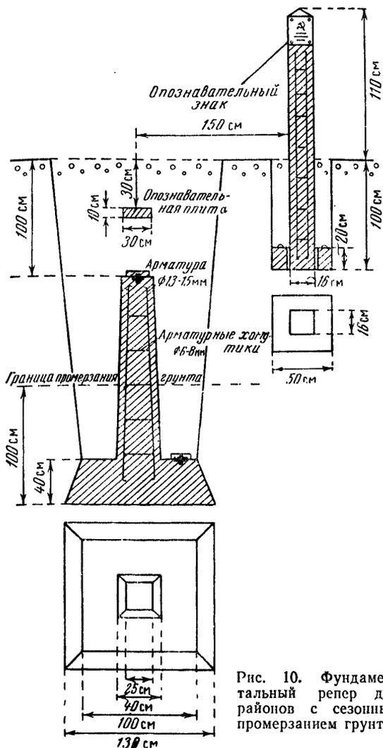
Рис. 10. Фундаментальный репер для районов с сезонным промерзанием грунтов
