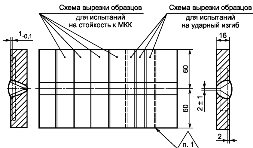
Рисунок В.8 — Контрольное сварное соединение
