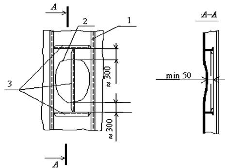
Рис. 5.3.3.2 Подкрепление бухтин и гофров ребрами жесткости:
