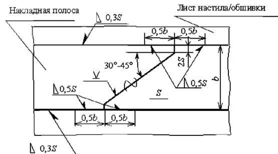
Рис. 5.2.1.5-1 Оформление стыков накладных полос
