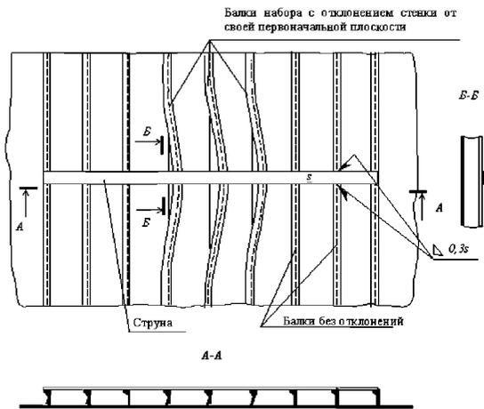
Рис. 5.3.4.2-1 Подкрепление балок набора с помощью струны
