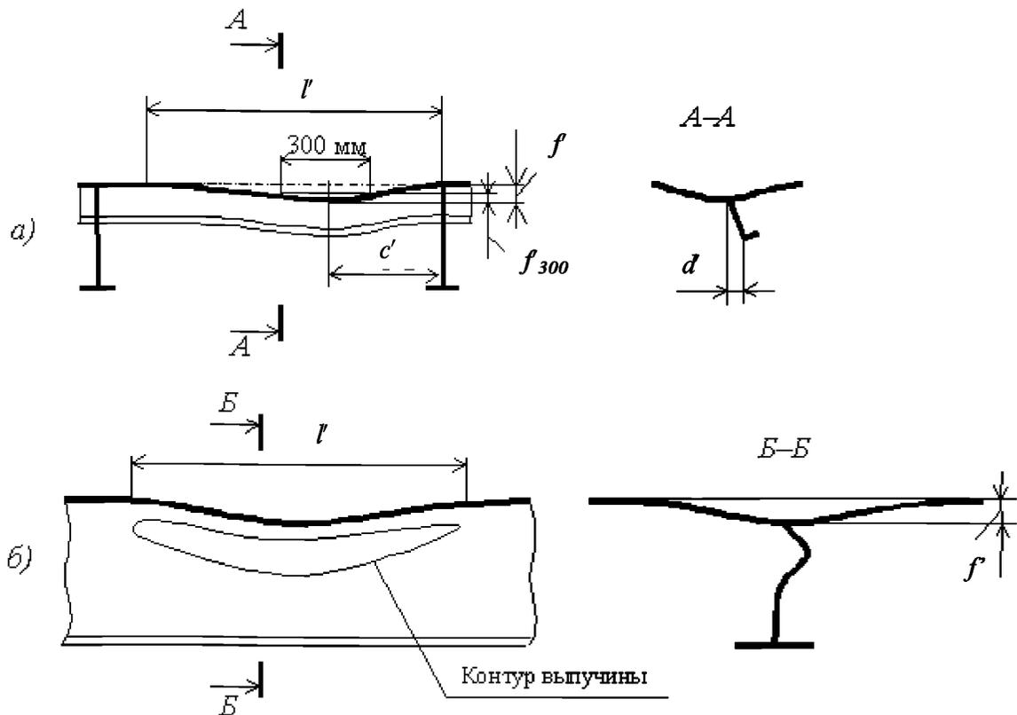
Рис 3.3.4.2 Измерение параметров швов:
