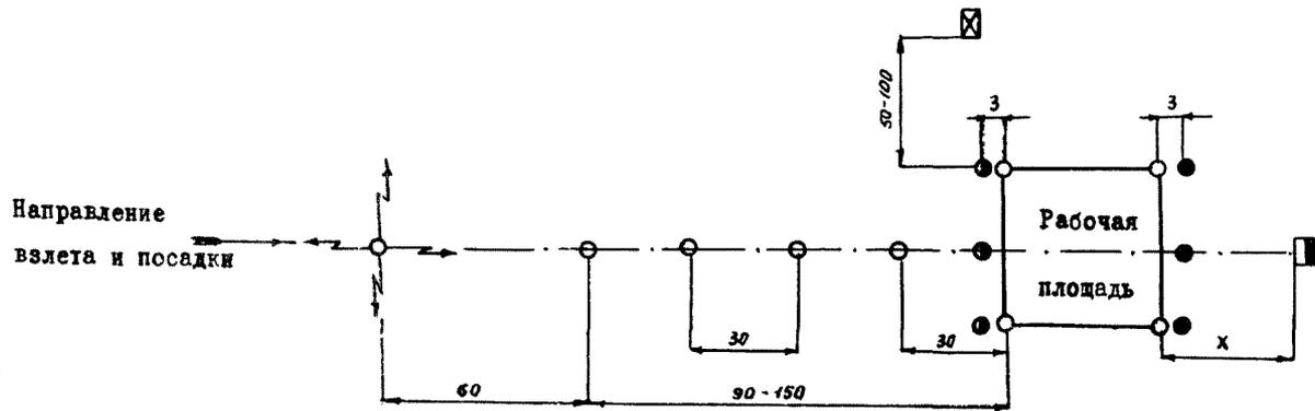
Рис. 9. Схема расположения светосигнального оборудования посадочных площадок
