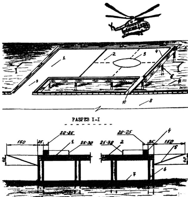
Рис. 7. Ограждение взлетно-посадочной платформы надводного вертодрома: 1 - надводная взлетно-посадочная платформа; 2 - рабочая площадь; 3 - центральное маркировочное кольцо; 4 - ограничительный брус (комингс); 5 - предохранительная сетка; 6 - свая; 7 - анватория; 8 - береговая территория вертодрома; 9 - трап; 10 - аварийный трап
