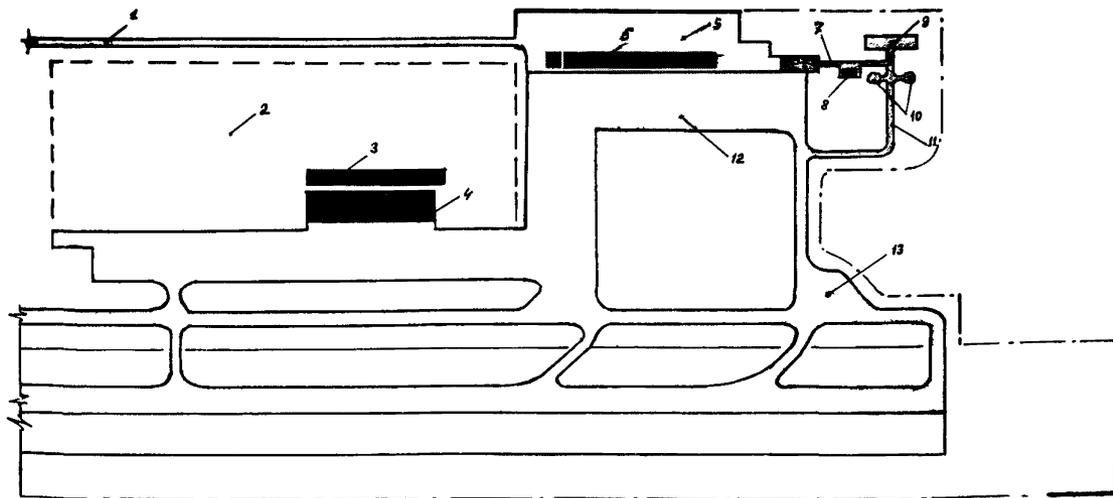
Рис. 6. Примерная схема расположения вертолетной станции на территории аэропорта: I - подъездная автодорога к аэропорту; 2 - территория СТТ; 3 - АТБ; 4 - ангар; 5 - аэровокзал аэропорта; 6 - привокзальная площадь; 7 - пешеходная аллея; 8 - пассажирский павильон вертолетной станции; 9 - ВПП для вертолетов; 10 - МС для вертолетов; 11 - РД; 12 - перрон аэропорта; 13 - территория аэродрома
