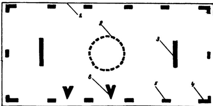
Рис. 1. Маркировка наземных вертодромов (посадочных площадок): 1 - граница ВПП (посадочной площадки); 2 - знак ограничения участка приземления при посадке по-вертолетному; 3 - стартовая линия; 4 - угловой пограничный знак; 5 - строчный пограничный знак; 6 - знак указания препятствий
