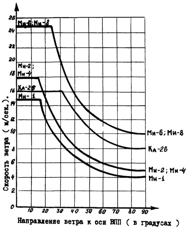
Рис. 2. Изменение допустимых составляющих бокового ветра в зависимости от углов направления ветра и оси ВП вертодромов
