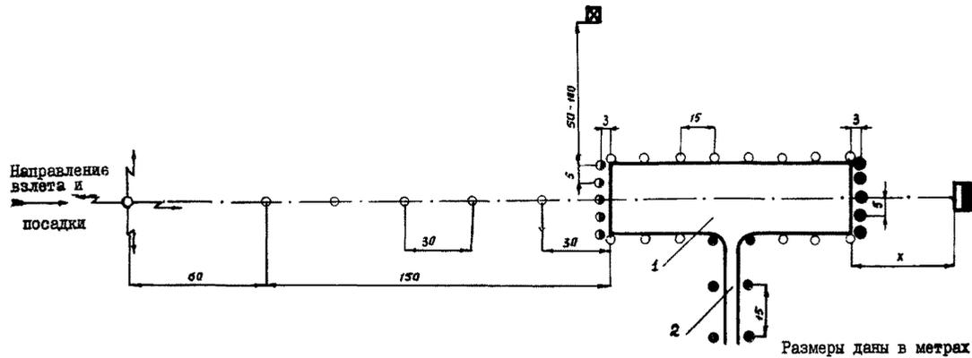
Рис. 8. Схема расположения светосигнального оборудования вертодромов:
