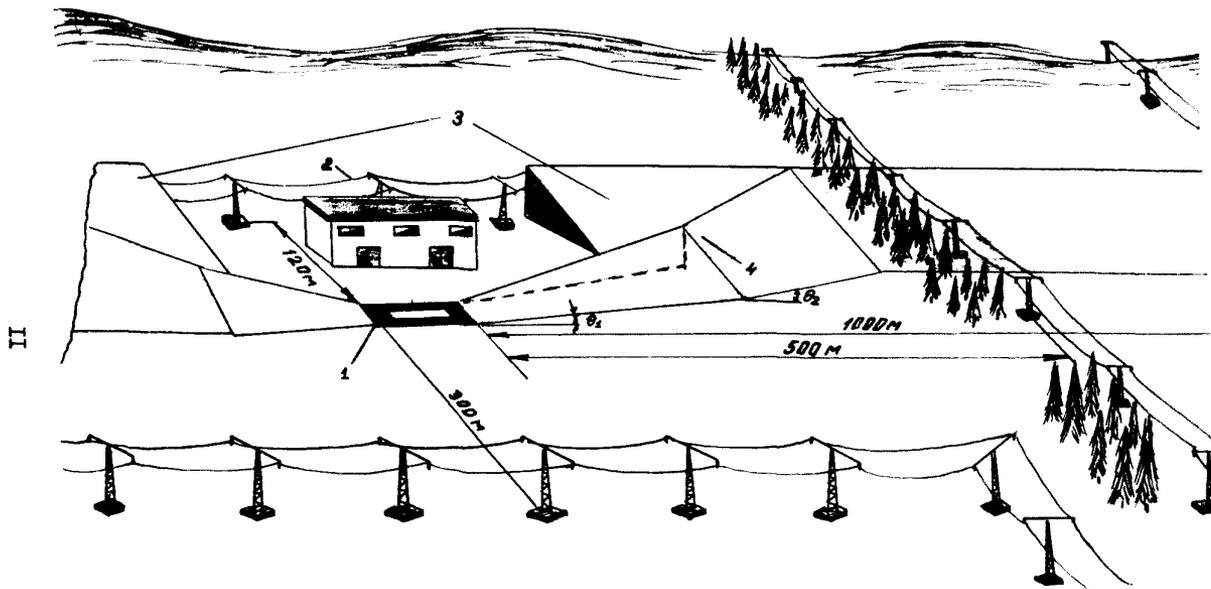
Рис. 1. Взаиморасположение вертодрома (посадочной площадки) и высоковольтной линии электропередач (ЛЭП): 1 - летная полоса; 2 - ЛЭП; 3 - условная боковая плоскость ограничения высоты препятствий; 4 - условная плоскость ограничения высоты препятствий в направлении взлета и посадки
