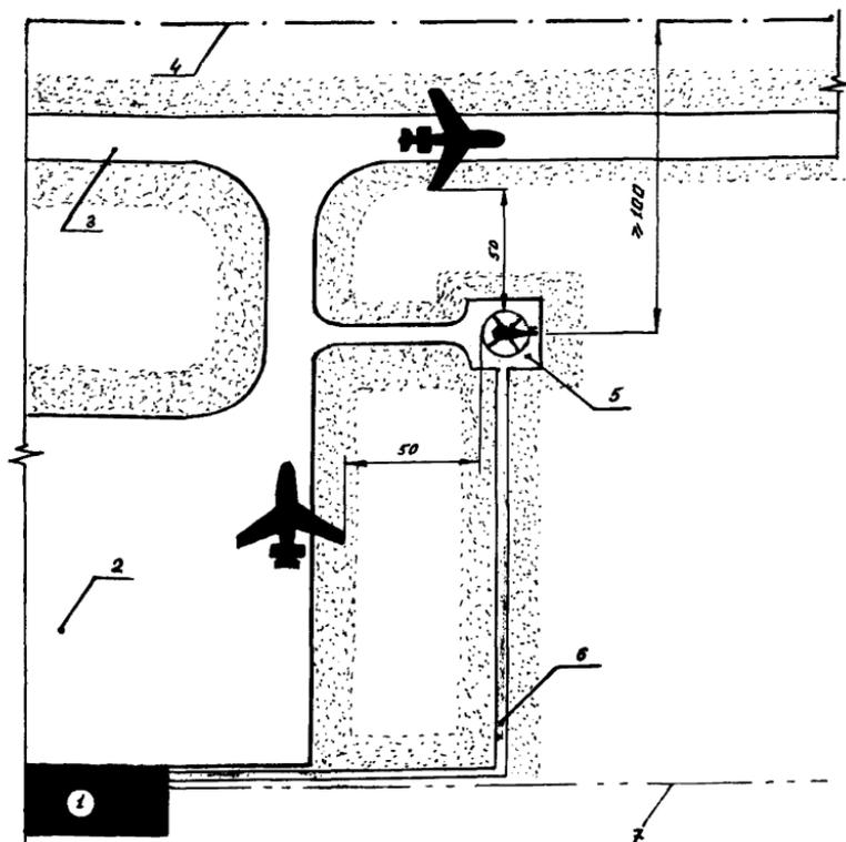
Рис. 7. Пример расположения посадочной площадки для вертолетов в аэропорту: 1 - аэровокзал; 2 - перрон; 3 - магистральная рулежная дорожка; 4 - граница летной полосы аэродрома; 5 - посадочная площадка; 6 - пешеходная аллея; 7 - ограждение аэропорта
