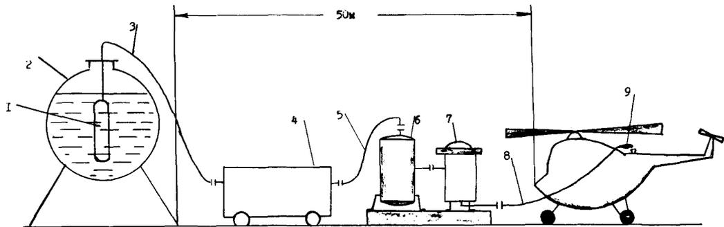
Рис. 2. Схема заправки вертолетов с помощью передвижных средств заправки: 1 - топливозаборник; 2 - емкость с топливом; 3 - рукав всасывающий; 4 - установка для заправки; 5 - рукав напорный; 6 - фильтр-сепаратор; 7 - фильтр тонкой очистки; 8 - шланг раздаточный; 9 - раздаточный пистолет
