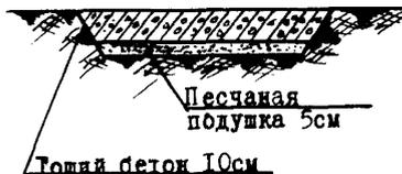
Рис. 3. Конструкция пограничных знаков грунтовых вертодромов
