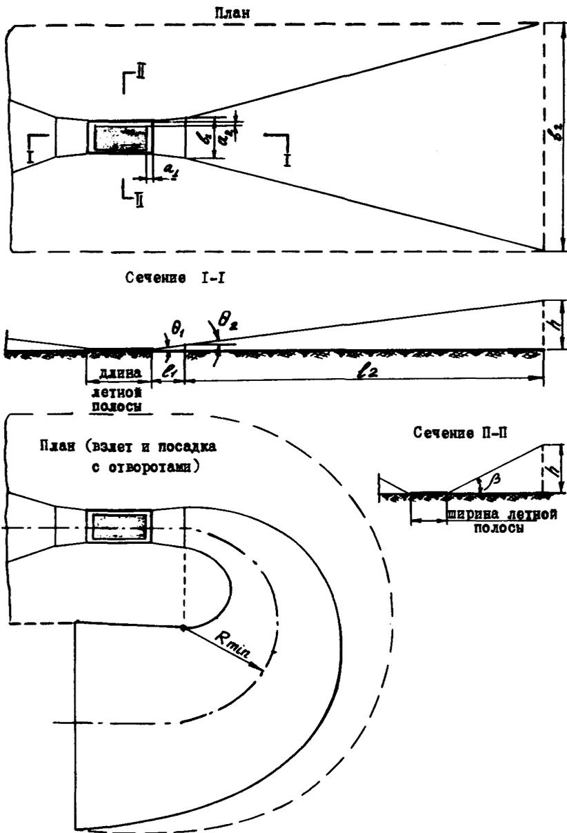
Рис. 4. Схема летной полосы и воздушных подходов вертодромов при полетах по правилам визуальных полетов
