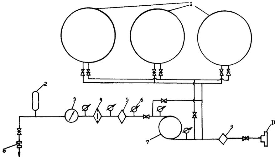
Рис. 1. Схема заправки вертолетов с помощью упрощенной системы ЦЭС:
