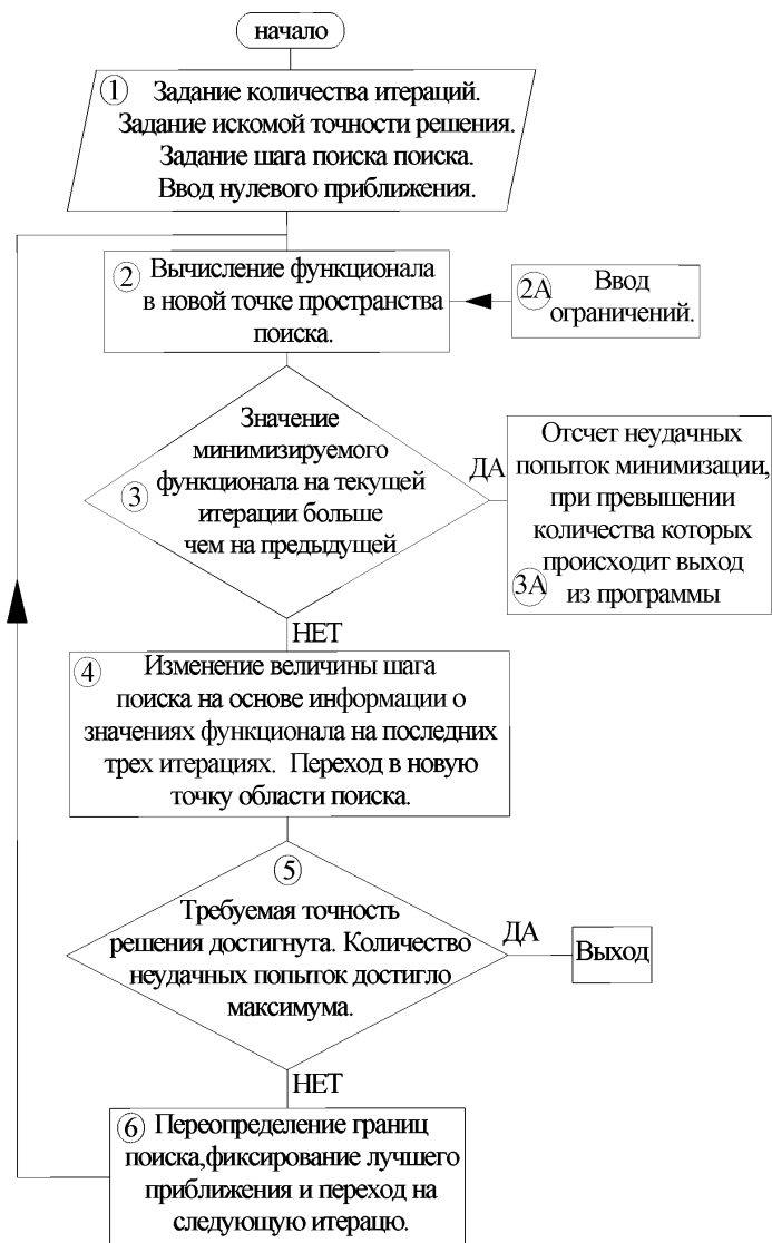
Рис. А1. Блок-схема алгоритма определения коэффициентов и степеней уравнения состояния методом случайного поиска с возвратом при неудачном шаге.
