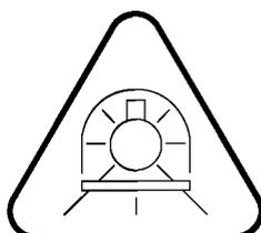
А.2 Символ лампы с экранированием, указывающий, что лампа может работать в светильнике без защитного экрана
