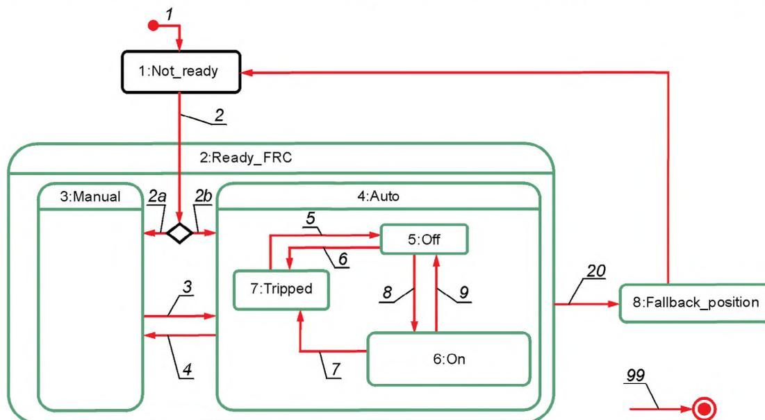
1, 2, 2a, 2b, 3, 4, 5, 6, 7, 8, 9, 20, 21, 99 — переходы состояний пускателя управления двигателем;
