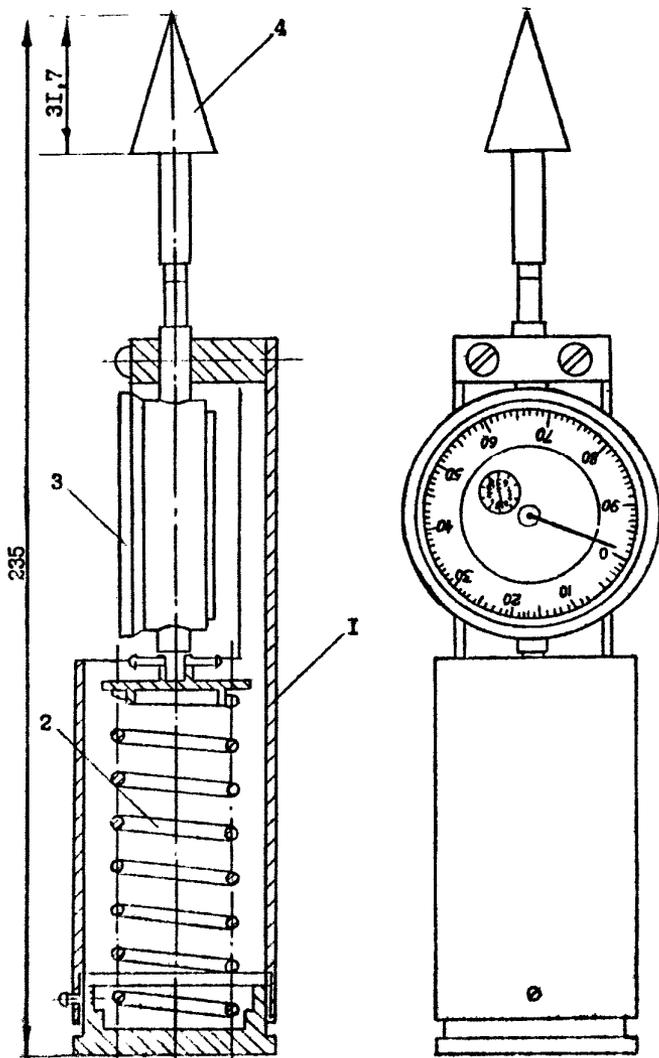
Рис. 2. Прибор для определения пластической прочности ячеистобетонной смеси.
