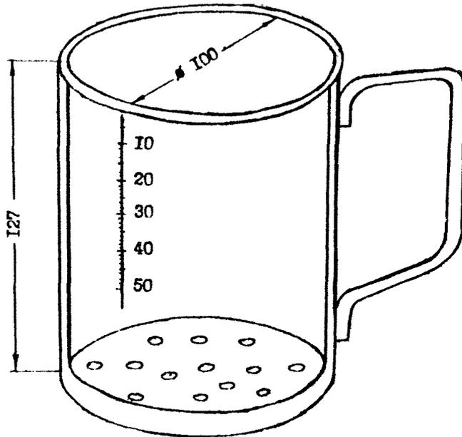
Рис. 1. Прибор для оценки качества технической пены.
