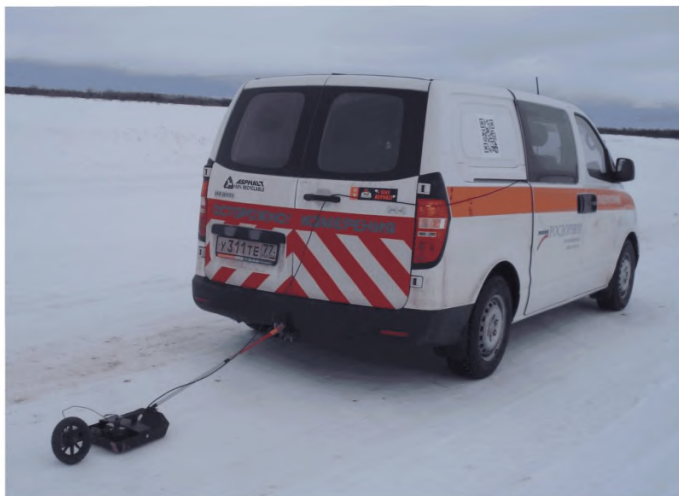
Рисунок 1 – Измерение толщины льда на ледовой переправе контактными антенными блоками АБ-1700
