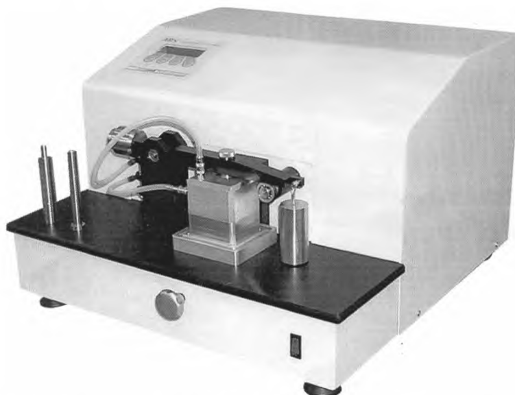
Рисунок А 2.1 — Полностью автоматический аппарат для оценки смазывающей способности в системе «шар-цилиндр»
