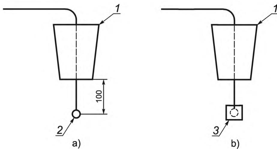
1 — пробка из силиконовой резины; 2 — рабочий конец температурного датчика; 3 — образец для испытания
