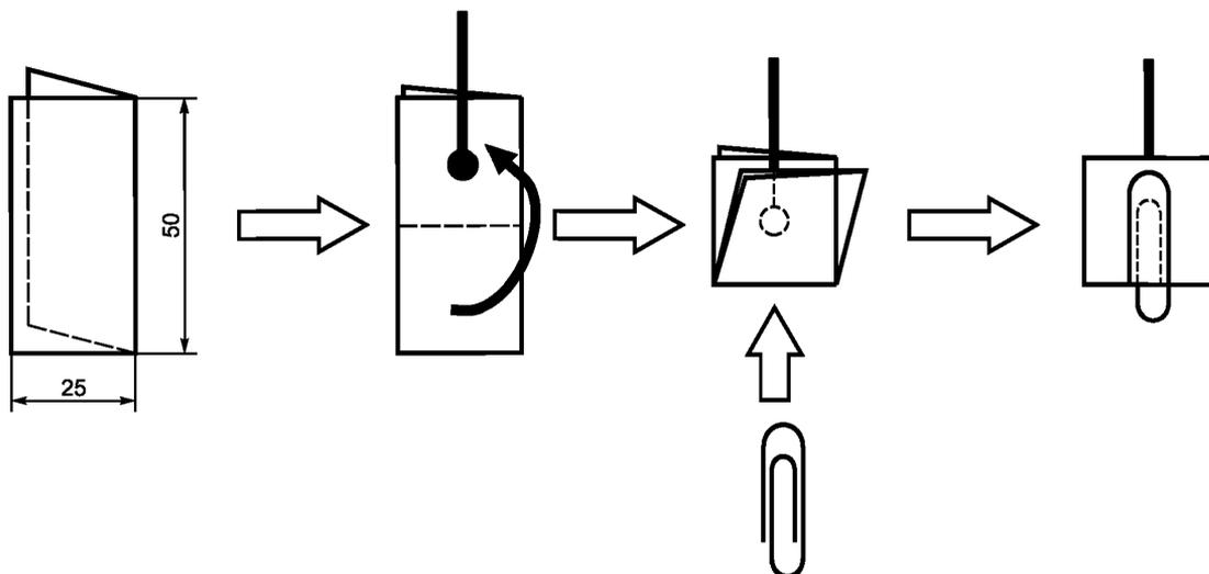
Рисунок 3 — Установка испытуемого образца
