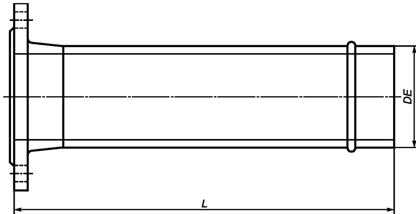
Рисунок В.7 — Патрубок, фланец — гладкий конец (ПФГ)
