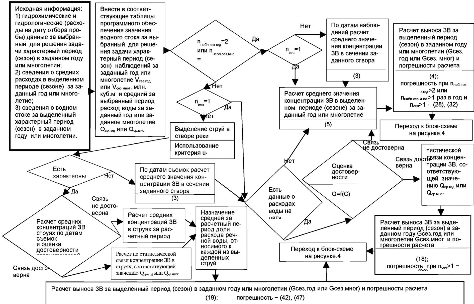
Рисунок 2 – Блок-схема процедуры расчета выноса ЗВ за выбранный период (сезон)
