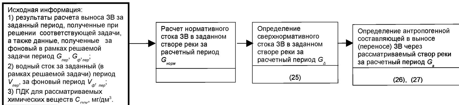
Рисунок 4 – Блок-схема процедуры расчета дополнительных данных, характеризующих антропогенное влияние ЗВ на водный объект за расчетный период (сезон, год, многолетие)
