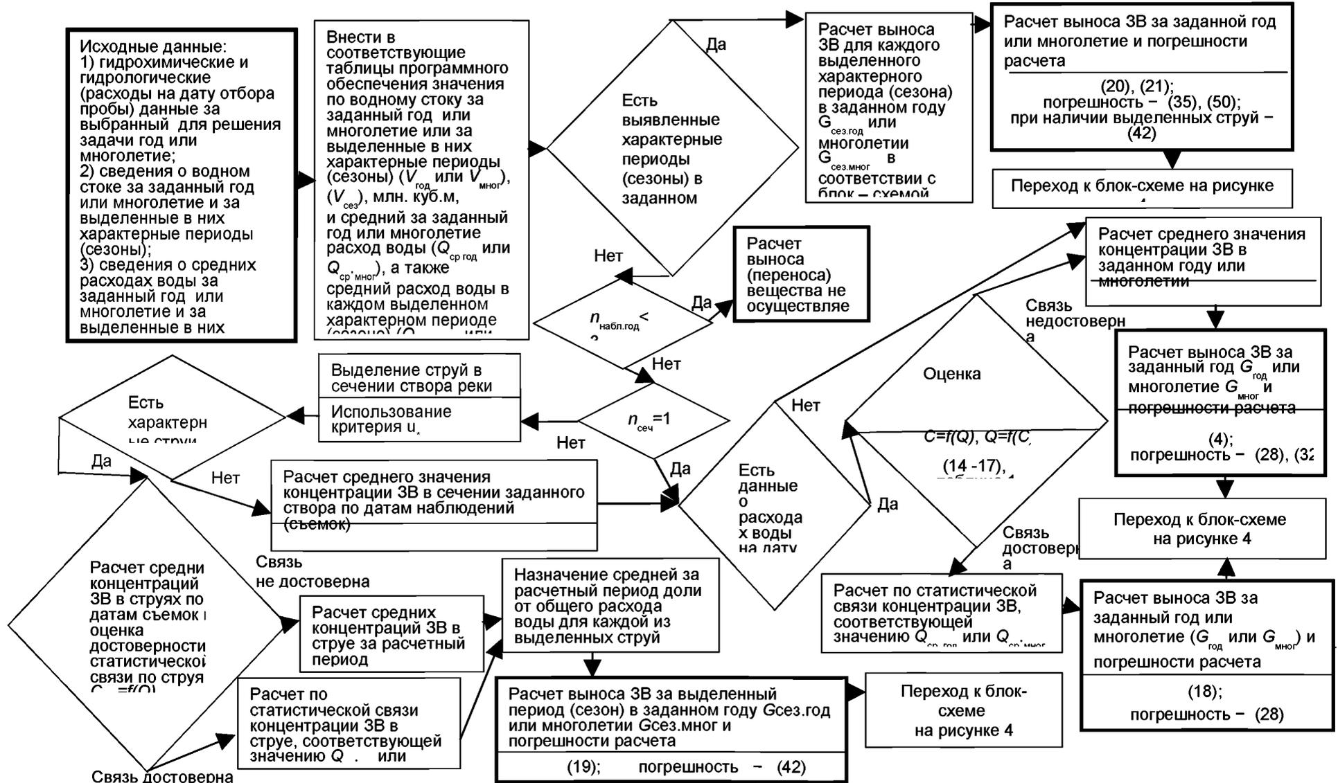
Рисунок 3 – Блок-схема процедуры расчета выноса (переноса) ЗВ за заданный год или многолетие
