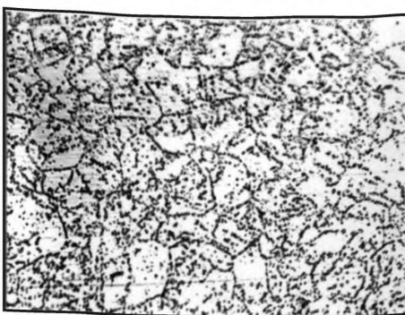
Балл 1, 500 x , электролитическое травление
