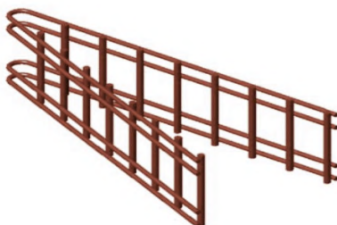
Рисунок 4.29 – Изогнутый каркас для предотвращения продавливания плит
