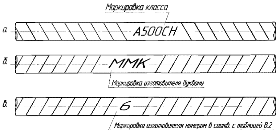
Рисунок В.5 – Маркировка проката надписью
