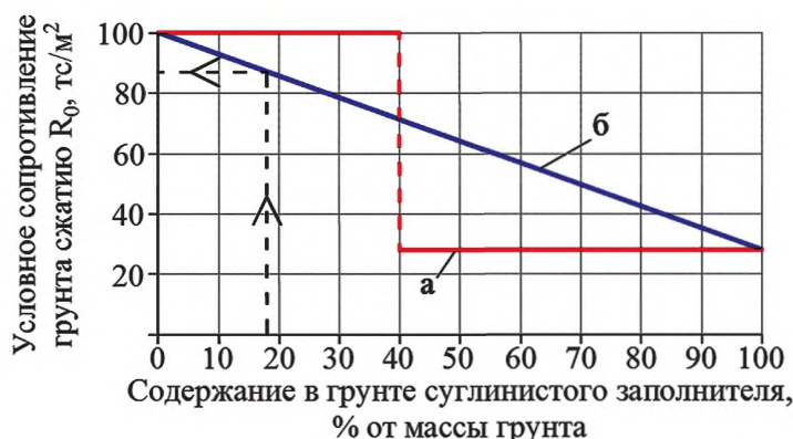
Рисунок Д.3 — Зависимости прочности галечника при сжатии от содержания суглинистого заполнителя полутвердой консистенции при расчете оснований на прочность (а) и при сейсмическом микрорайонировании (б)
