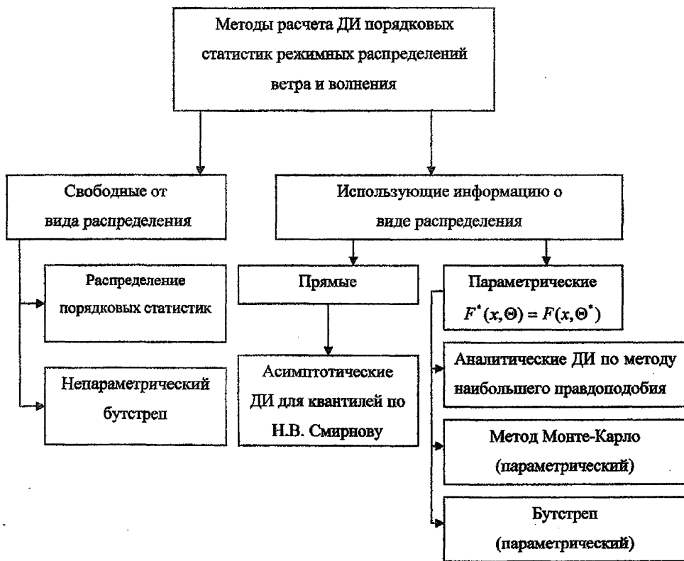
Рис. 5.2 Методы расчета доверительных интервалов порядковых статистик (квантилей) режимных распределений ветра и волнения
