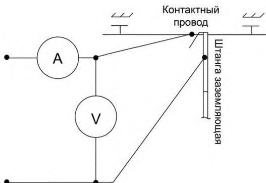
Рисунок 3 — Принципиальная схема для измерения сопротивления контура «токопроводящее звено — контактный провод»
