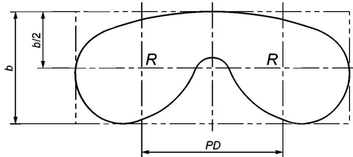
$b$  — расстояние между касательными к верхней и нижней частям смотрового элемента;
