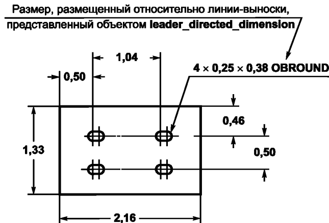
Рисунок 8 — Размер, размещаемый относительно линии-выноски
