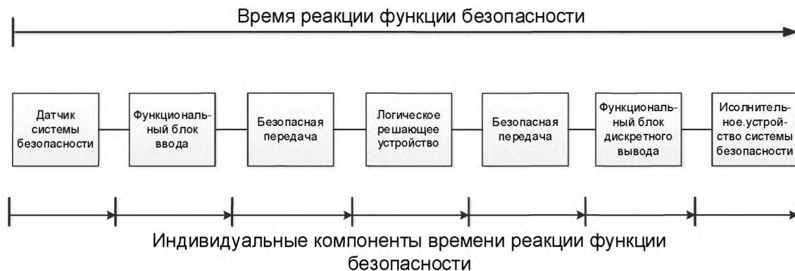
Рисунок 31 — Пример компонентов времени ответа функции безопасности
