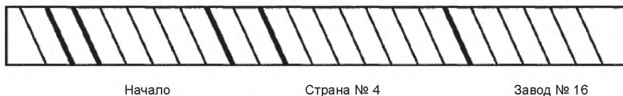
Рисунок 5 — Пример маркировки для идентификации страны происхождения и завода (с применением утолщенных ребер)
