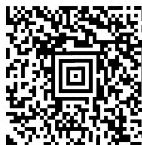
Рисунок А.5 — Символ Aztec code с повреждением фиксированных шаблонов
