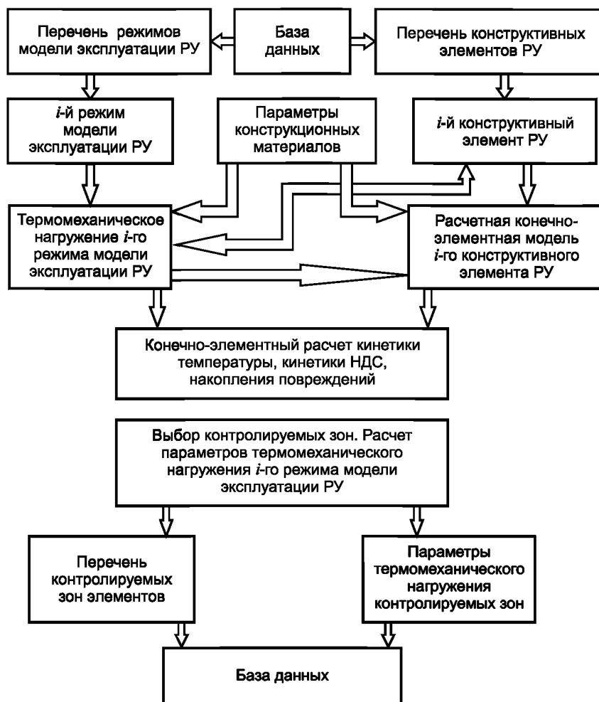
Рисунок 8 — Выбор контролируемых зон критических конструктивных элементов РУ. Расчет параметров термомеханического нагружения зоны
