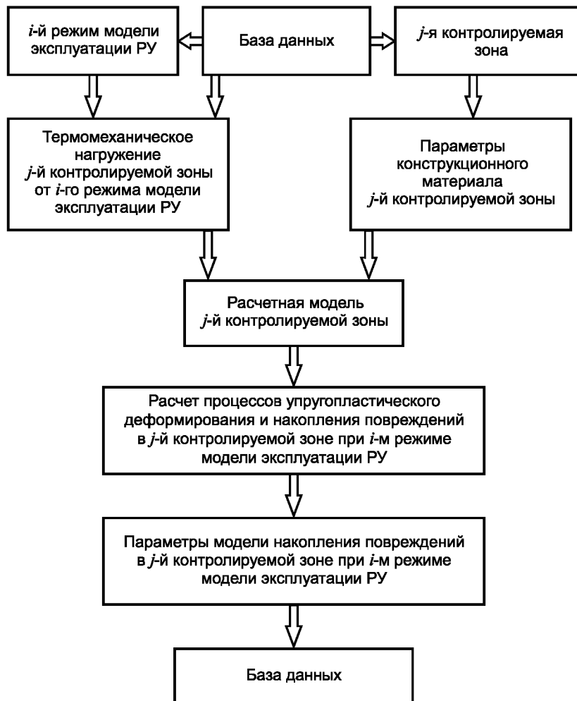
Рисунок 9 — Расчет параметров модели накопления повреждений в j -й контролируемой зоне при i -м режиме модели эксплуатации РУ
