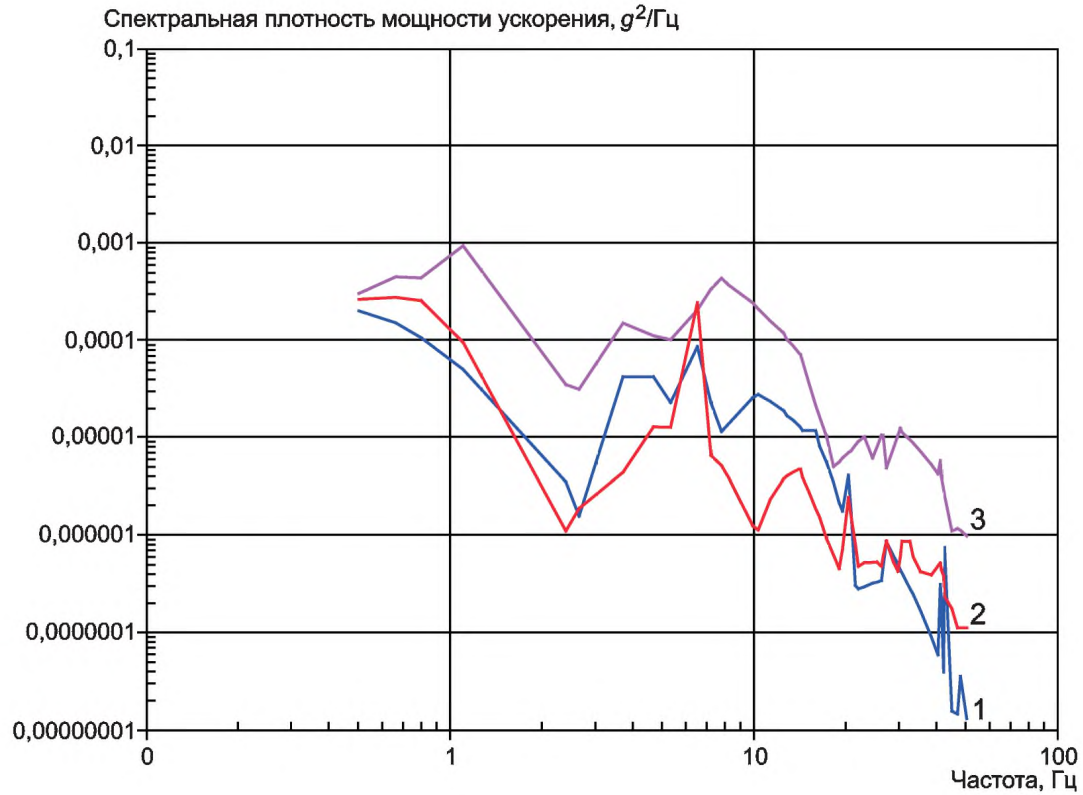
Рисунок 22 — Измерение V1 (см. таблицу 6) на поддоне самолета Boeing 747
