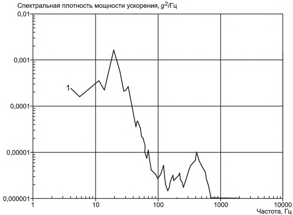
Рисунок 20 — Измерения вертикальной вибрации у контейнера в хвостовой части на самолете VC10 (реверсное торможение, a_{rms} = 0,141g , без шума бортовой системы)
