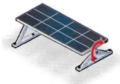
Рисунок 3 — Пример наклонной одноосной системы слежения за Солнцем
