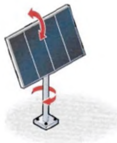
Рисунок 7 — Пример двухосной системы слежения за Солнцем с вертикальной основной осью
