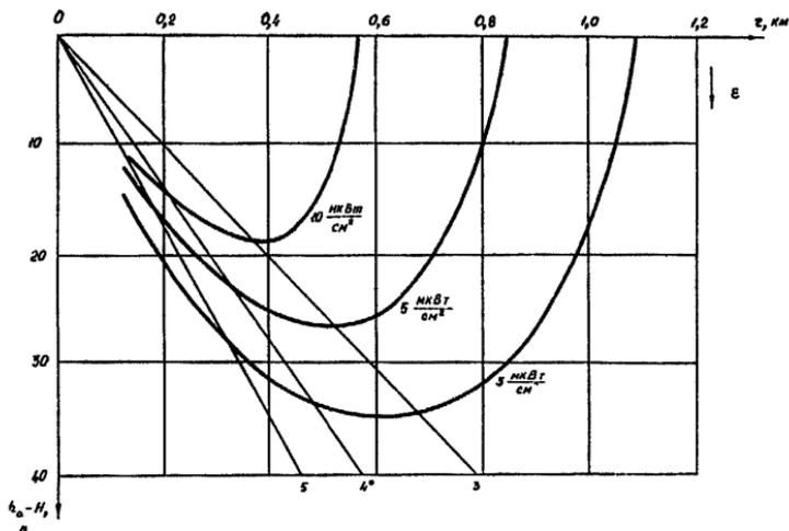
Рис. П. 2.4. ВДИ радиолокатора «Экран» и «ДРЛС=7 см» уровней 3,5 и 10 мкВт/см<sup>2</sup>,  $2\theta_{0,5}=8^\circ$ .
