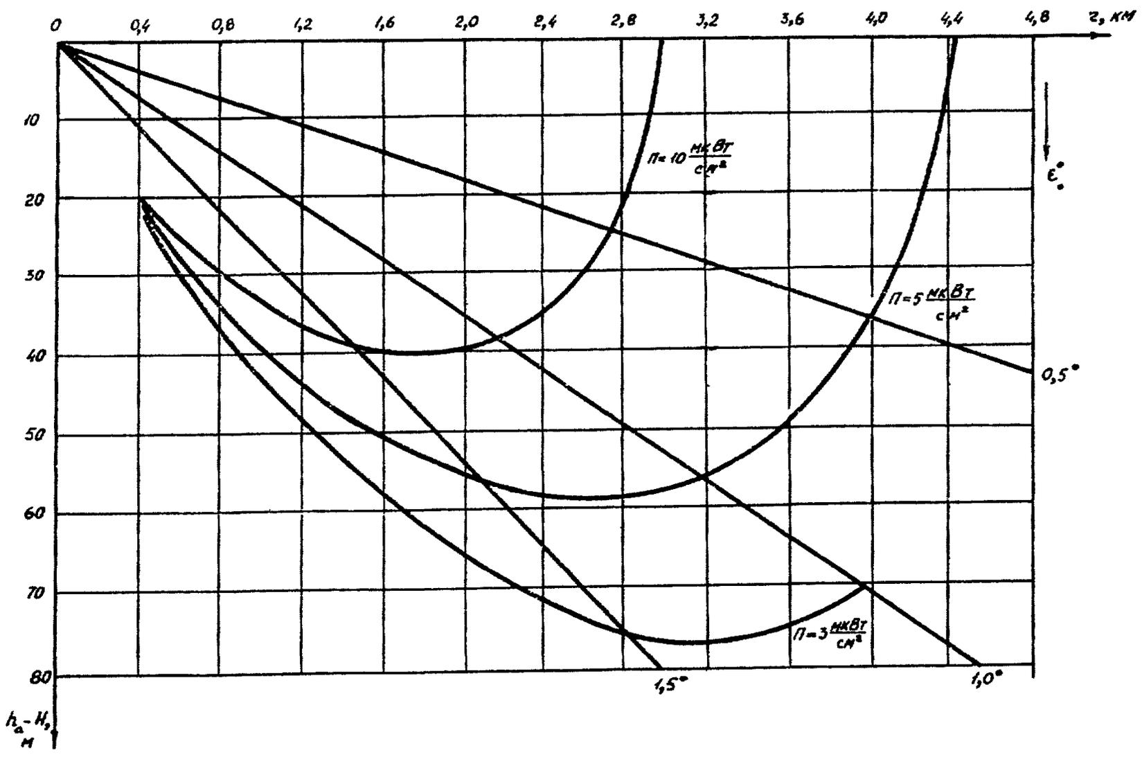
Рис. П. 2.2. ВДН радиолокатора П-35М для уровней 3,5 и 10 кВт/см<sup>2</sup>
