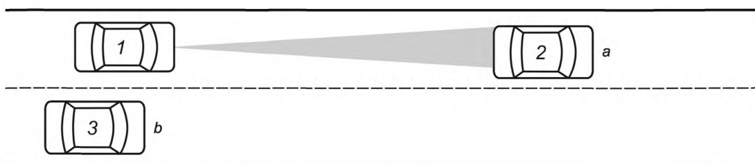
1 — управляемый автомобиль; 2 — преследуемый автомобиль; 3 — впереди идущий автомобиль в соседней полосе; a — скорость преследуемого автомобиля, равная v_{\text{vehicle\_end}} ; b — скорость впереди идущего автомобиля в соседней полосе, равная v_{\text{vehicle\_start}}
