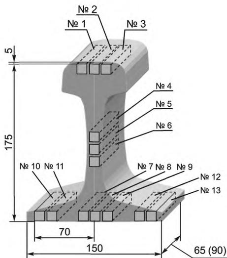
б) Схема вырезки образцов для испытаний на растяжение
