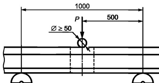
Рисунок 3 — Схема нагружения образцов для испытаний
