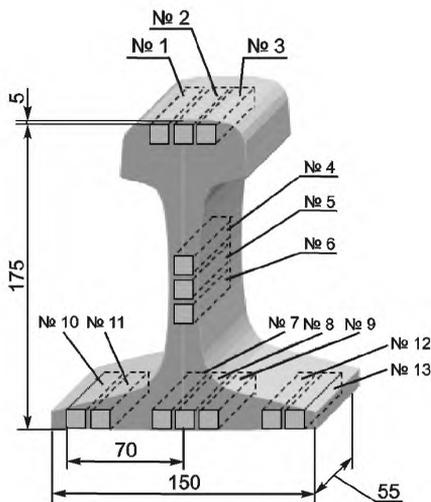
б) Схема вырезки образцов для определения ударной вязкости
