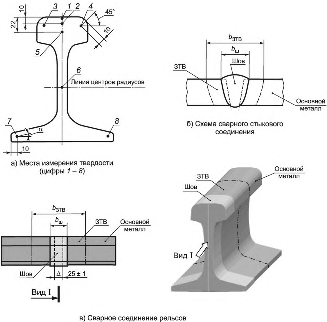
Рисунок 1 — Схемы сварного стыкового соединения рельсов
