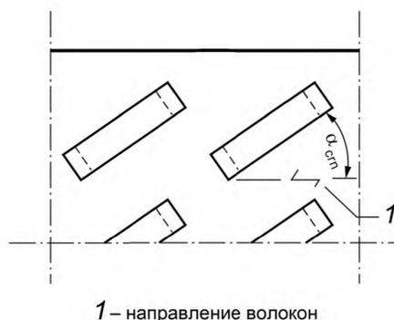
Рисунок 2 — Угол между направлением перекладки скобы и направлением волокон
