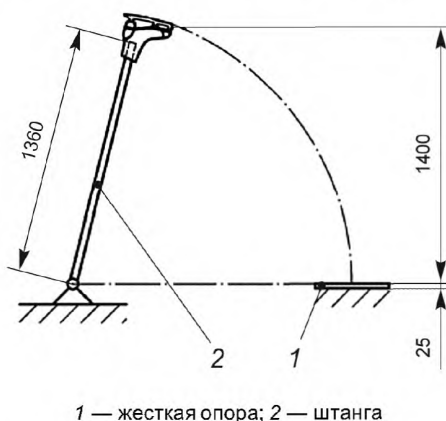
Рисунок 5 — Испытание стойкости несъемного конька к удару в вертикальном положении передней частью полоза конька
