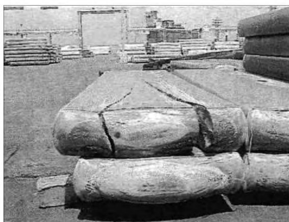
Рисунок А.8 — Трещина донная
