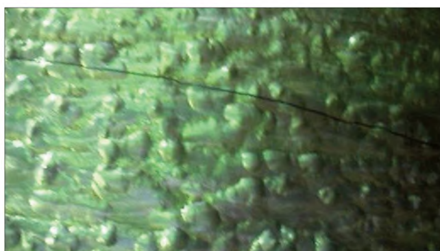
Рисунок А.5 — Трещина радиальная в сплошном круглом слитке
