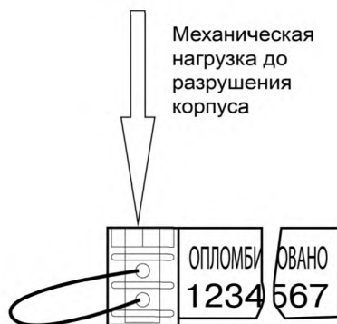
Рисунок Б.1 — Пример повреждения проволочной роторной пломбы
