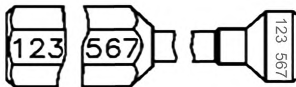
Рисунок Б.5 — Пример разрушения ЗПУ стержневого типа
