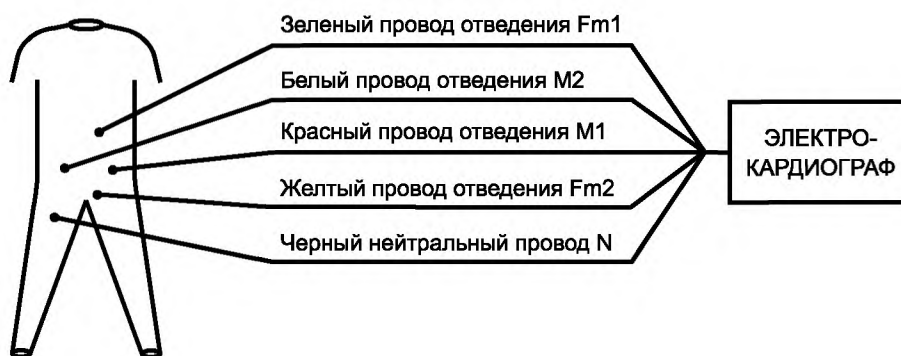
Рисунок ВВ.1а — Отведения и их цвет кодировки при регистрации ЭКГ плода (см. таблицу ВВ.2)
