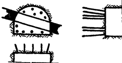
Рис. 33. Форма паспорта буровзрывных работ для сотрясательного взрывания (проходка по пласту).
