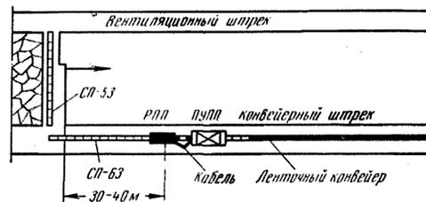
Рис. 2. Установка ПУПП над скребковым конвейером
