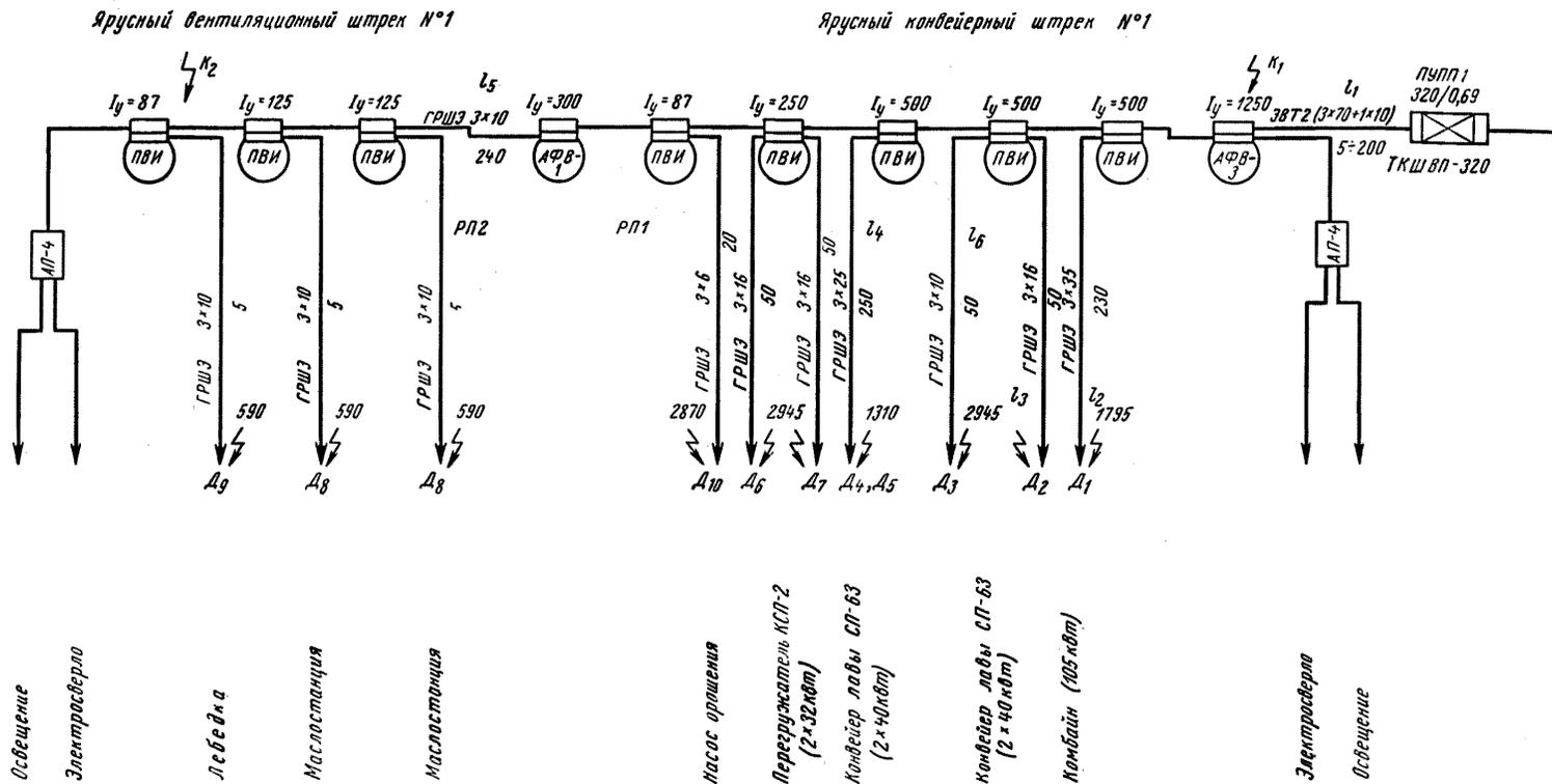
Рис. 4. К расчету системы электроснабжения участка угольной шахты
