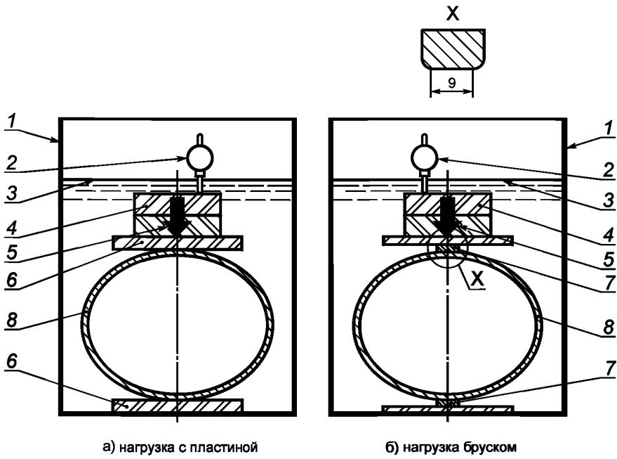
1 — емкость с водой; 2 — средство измерения кольцевой деформации;
