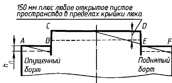
Рис. ПЗ.1.8-1. Распределение пустот в плоскости поперечных сечений отсеков, когда часть отсека в пределах длины люковых вырезов не имеет продольной переборки
