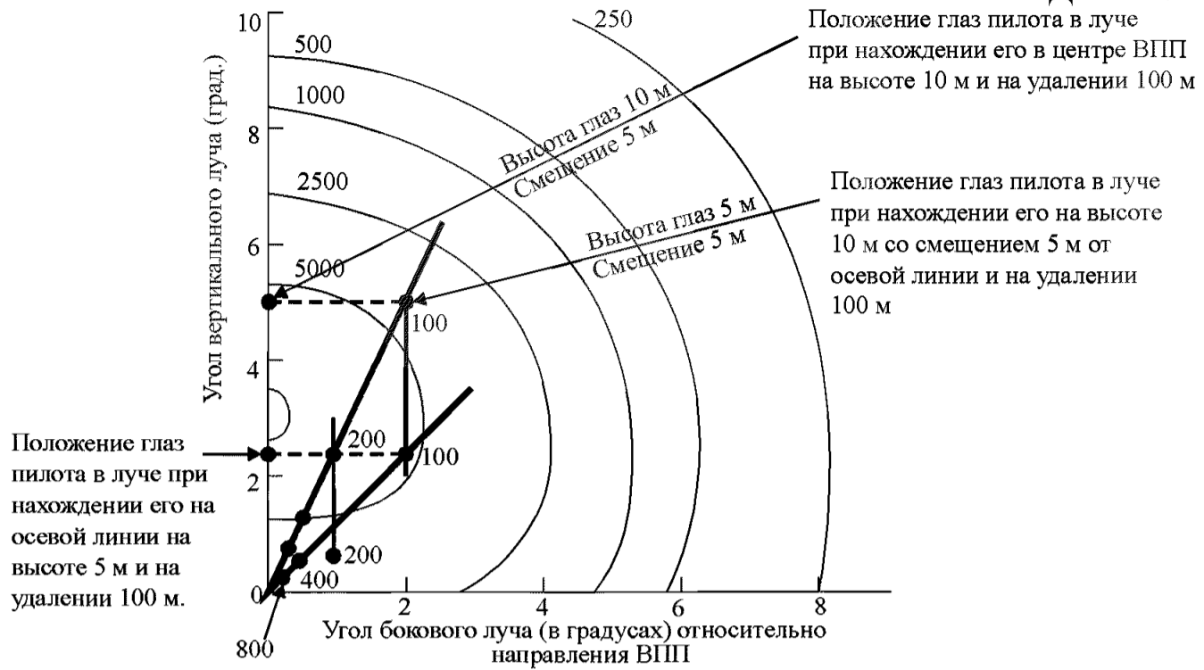
Рисунок 7 Диаграмма изокандел для осевого огня ВПП ( при максимальном режиме интенсивности с продольным интервалом между огнями 30 м) с указанием положения глаз пилота в луче при различных высотах уровня глаз и различном удалении от последнего видимого огня
